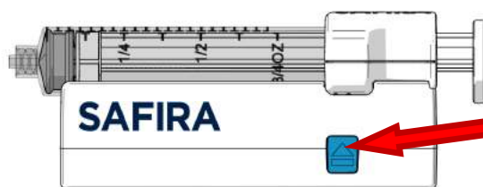
Esquema #5: Presione el botón de liberación cuadrado para extraer la jeringa
